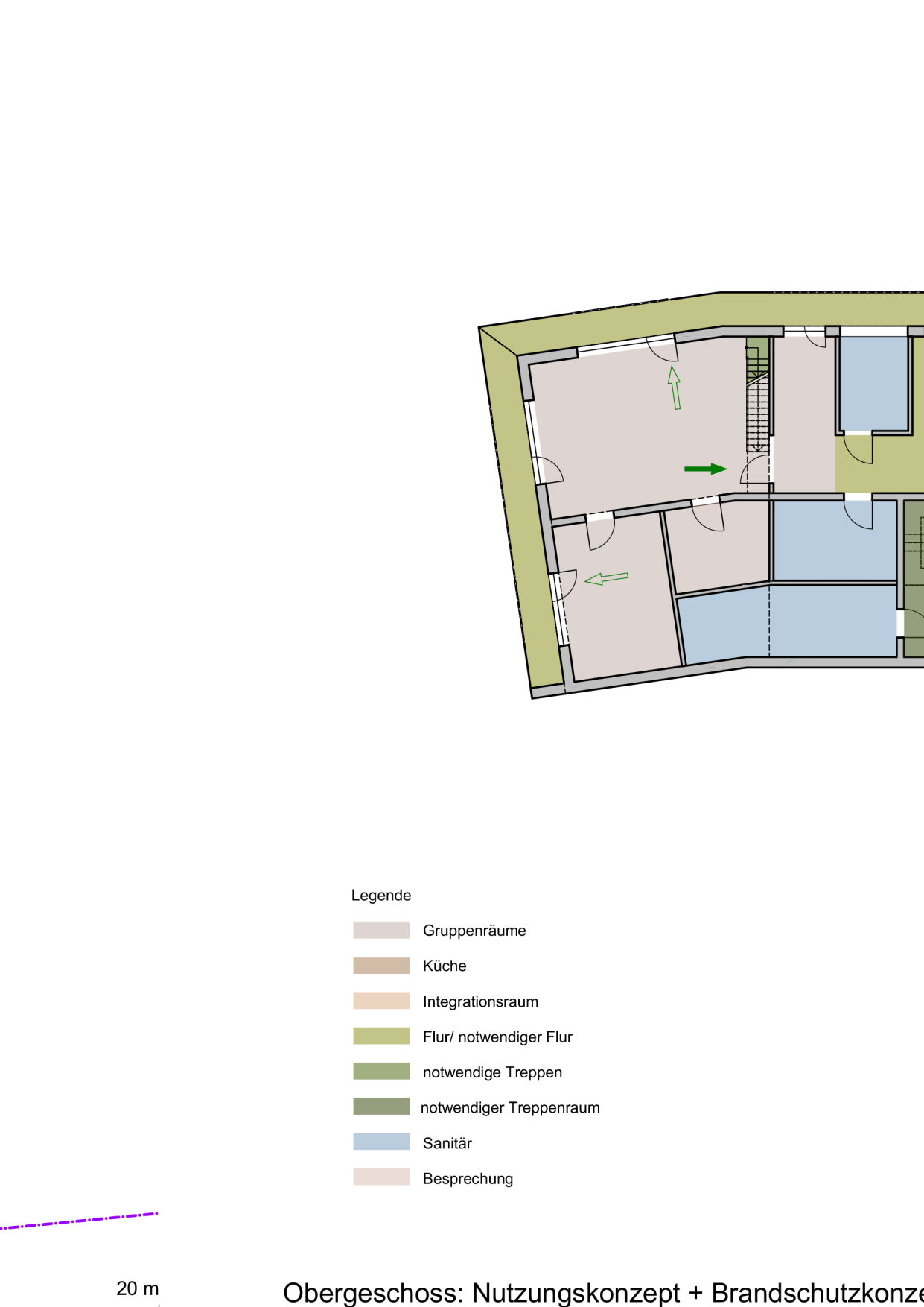
Obergeschoss: Nutzungskonzept + Brandschutzkonzept M1:200
