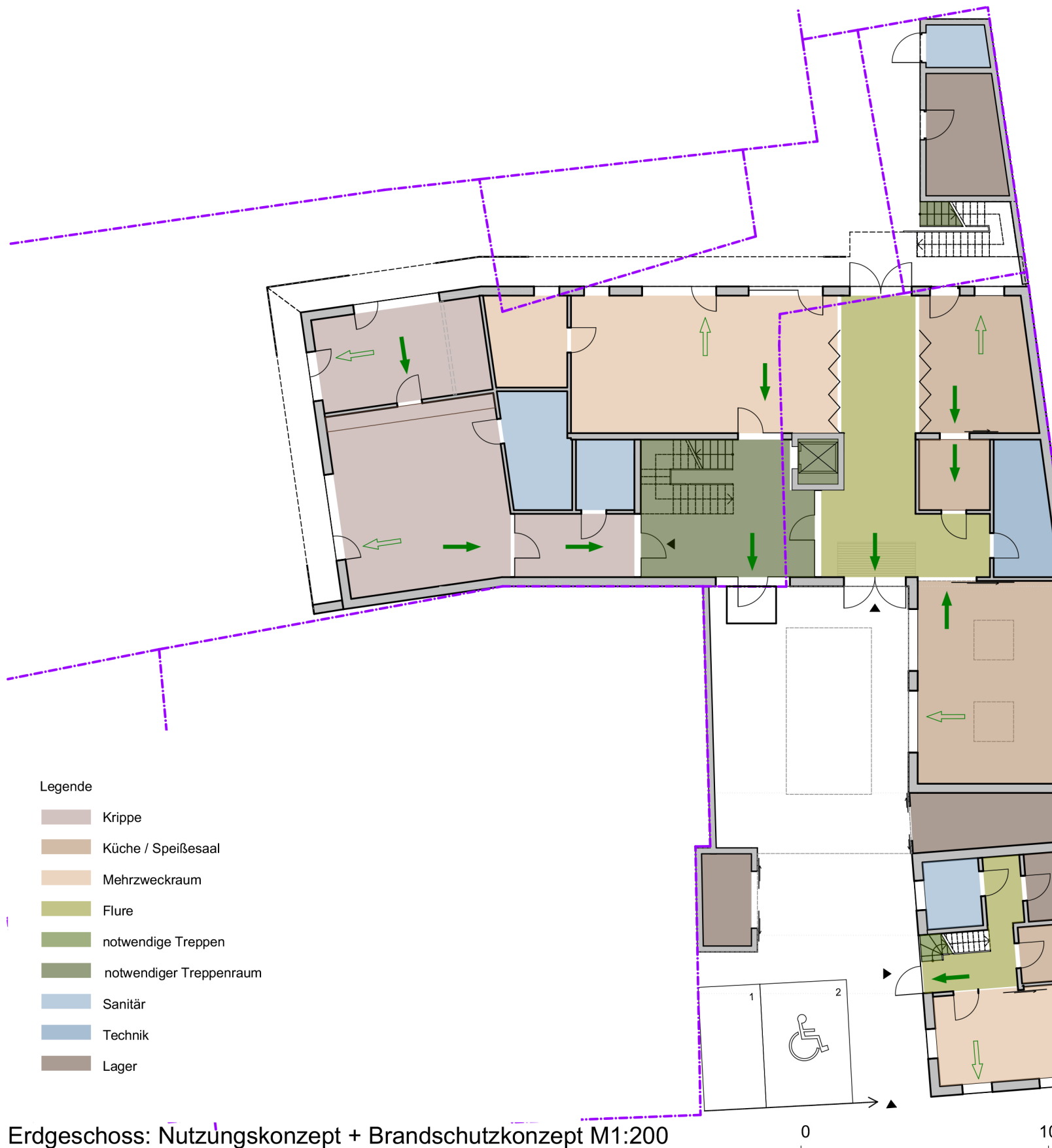
Erdgeschoss: Nutzungskonzept + Brandschutzkonzept M1:200
